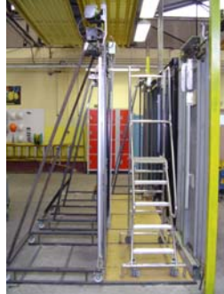
Un escabeau mobile circulant entre porte cabine et palière, permet l'accès aux parties hautes des portes en sécurité
