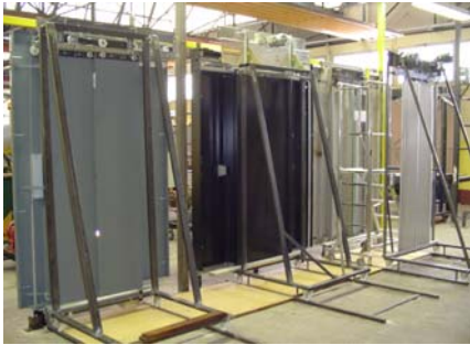
Portes cabine mobiles montées sur chariot guidé
