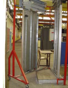
Autre solution avec porte palière pivotante
