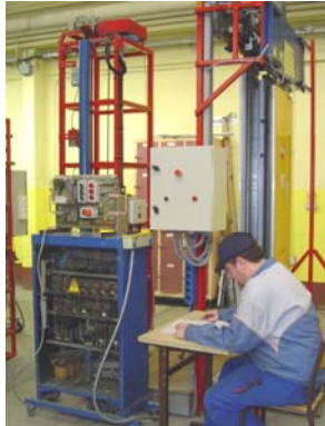
Manœuvre à blocage, basculeur d'étage et sélecteur rotatif, porte coulissante 2 vantaux, gaine et cabine modélisées.
